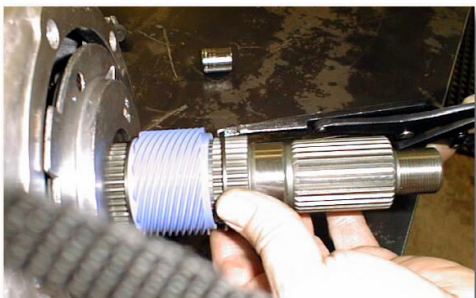
(Fig. 9A) Speed-o-Ring Gear Install
